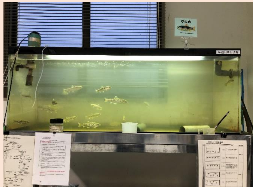
浄水場内水槽による魚態監視
