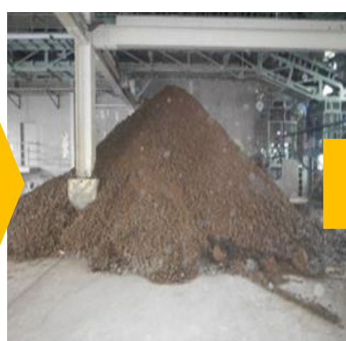
脱水ケーキヤード
