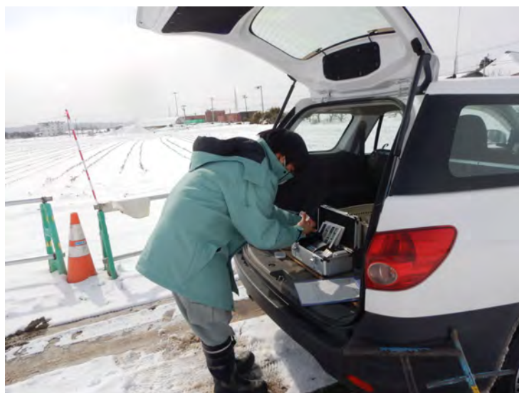
管路更新に伴う通水切替え時の採水・水質検査状況
