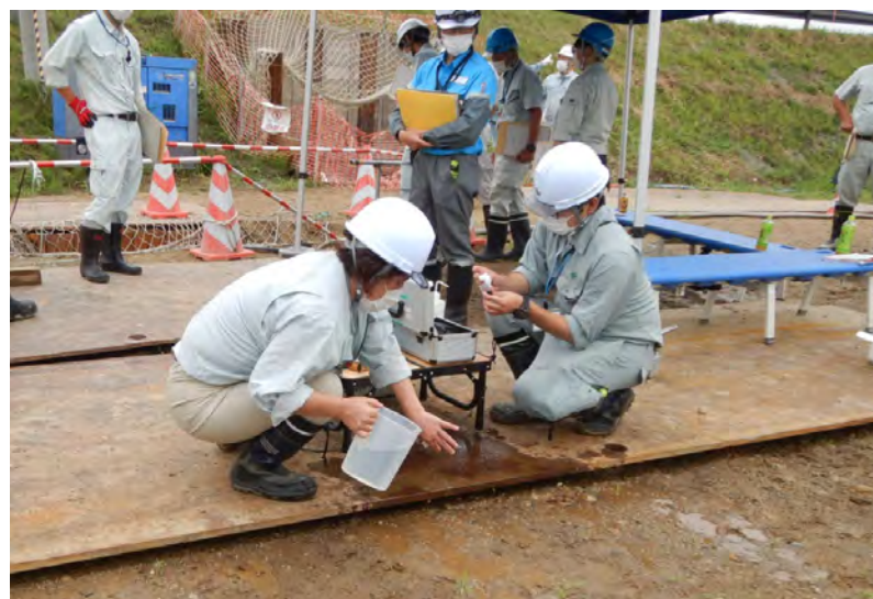
管路更新に伴う通水切替え時の採水・水質検査状況
