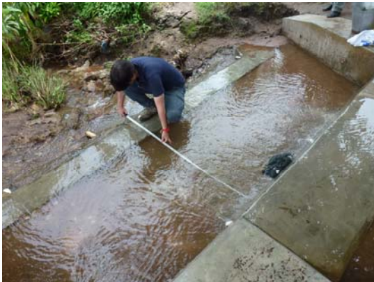
写真 63, 64 : 粗朶工法設計のための現地確認と測定
