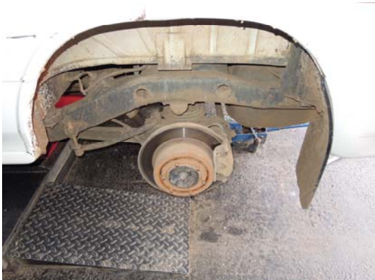
写真 89, 90:車台の亀裂（溶接にて応急処置済）
