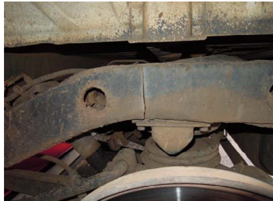
写真 89, 90:車台の亀裂（溶接にて応急処置済）
