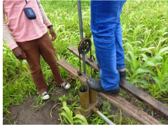
写真 54 : 足踏み式ポンプ (旧式 : インド製)
