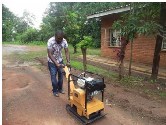
写真 83, 84: 振動コンパクトの作動確認状況
