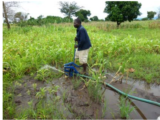
写真 55, 56 : 足踏み式ポンプ (新式 : ケニア製)
