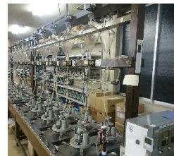
転倒ます型雨量計の調整
