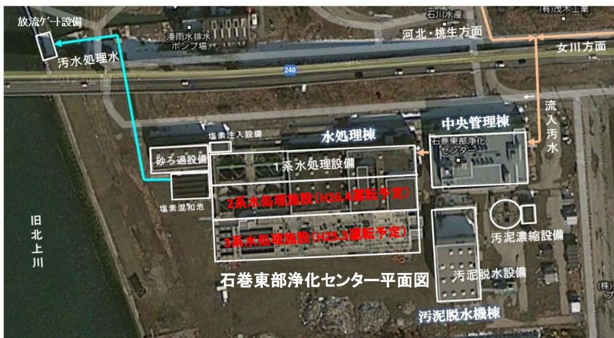
石巻東部浄化センターでの汚水の処理は、昨年4月からの「一次放流(沈殿+消毒)対策」、今年4月からの仮設設備による「簡易生物処理」対策を行っていましたが、今回、第1系列水処理施設が震災前と同様の「高級処理(生物処理)」へと移行しました。
