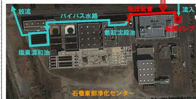
仮設沈殿池に流入した汚水は、大きなゴミや砂を沈殿させた後、塩素消毒をしてから旧北上川へ放流しました。
