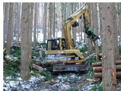
林業機械による所有林の間伐作業
