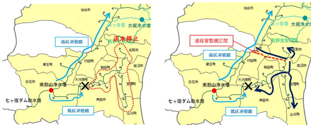
連絡管整備前(左)と連絡管整備後 連絡管の整備により高区系管路から低区系管路へ送水が可能に
