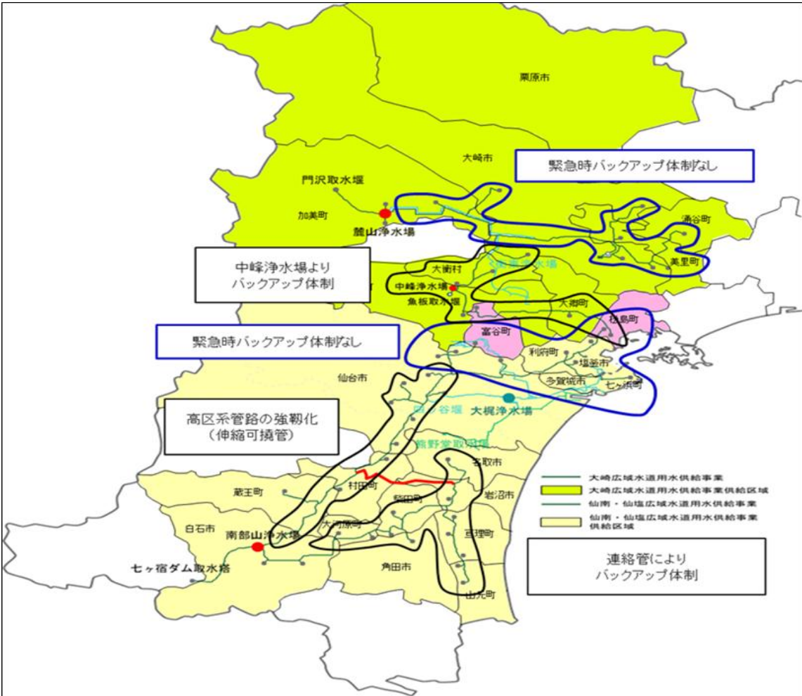
送水管のバックアップ体制の現状
