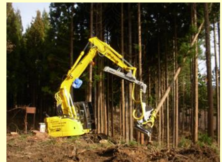
ハーベスタによる伐採作業現場
