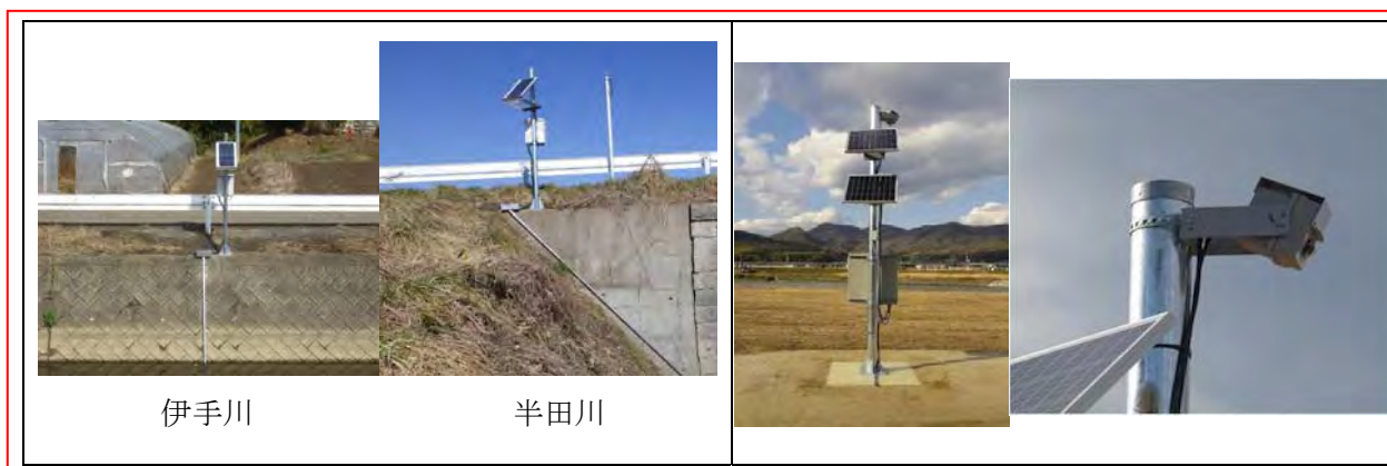
図 2-44 危機管理型水位計および簡易型河川監視カメラ (簡易型河川監視カメラ出典：国土交通省)
