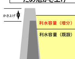
ため池かさ上げ
