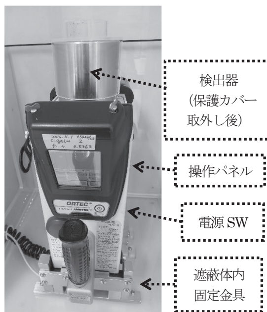
図5 大型遮蔽体内に設置された Ge 検出器
