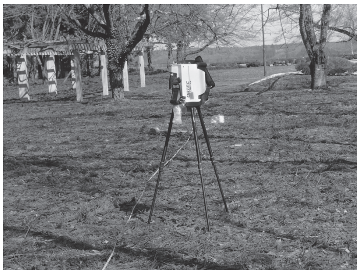
図8 可搬型 Ge 検出器による in situ 測定風景
