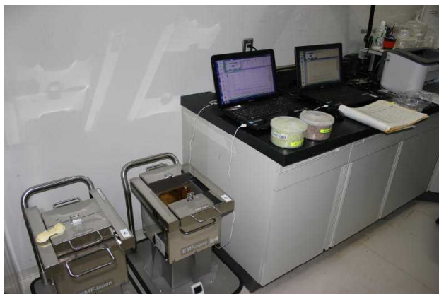
牧草を検査するNaIシンチレーション検出器
