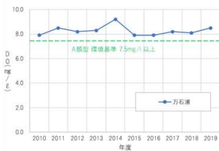
図. 12 万石浦における DO (溶存酸素量) の経年変化図
