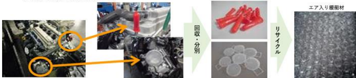
(エンジンの例) プラスチック製キャップ
