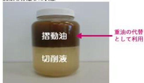
廃液を分離した状態
