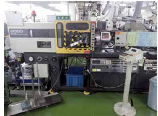
▲油圧式射出成形機（更新前）
