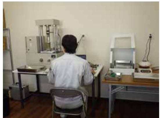
▲一軸圧縮強さ測定状況
