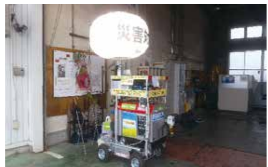
▲小型移動式 SVO 燃料発電機 (災害対策用)
