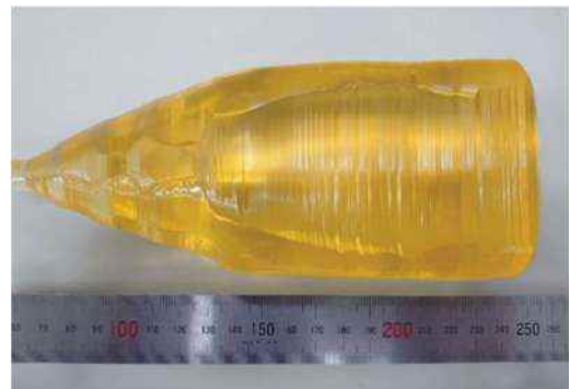
▲上記装置を用いて製造した3インチ径ランガサイト型圧電単結晶
