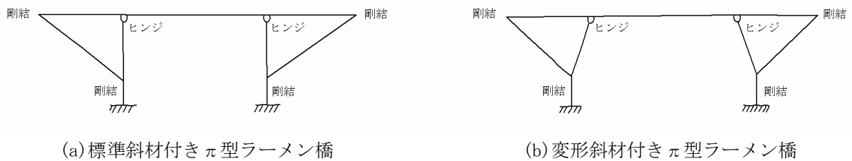
図5-67 骨組構造の解析モデル
