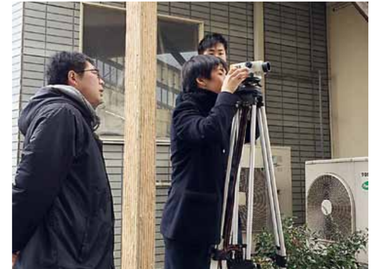
津波痕跡の高さを測定
