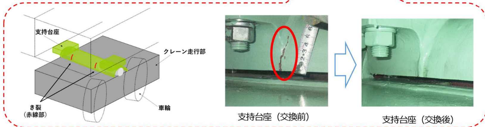
1号機 原子炉建屋天井クレーン走行部支持台座のき裂に係る概要図
