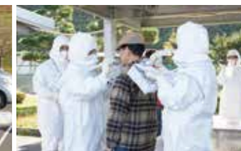
サーベイメータによる住民の放射性物質の付着状況の検査
