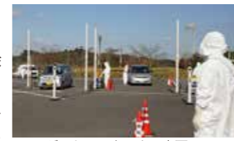
ゲートモニタによる車両の放射性物質の付着状況の検査
