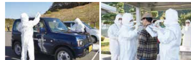
サーベイメータによる車両の放射性物質の付着状況の検査
