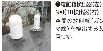
② 電離箱検出器(左)・NaI(Tl)検出器(右) 空間の放射線(ガンマ線)を検出する装置です。
