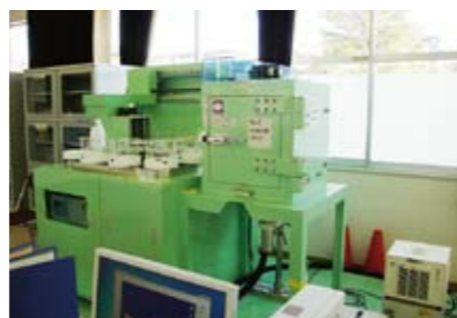
精密型放射能測定器(ゲルマニウム半導体検出器)
