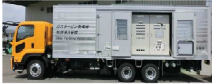
ガスタービン発電機
