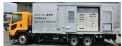
ガスタービン発電機
