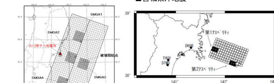
1978年宮城県沖地震(M7.4)の観測記録を踏まえた想定宮城県沖地震の断層モデル(A1断層)【地震本部(2005)】
