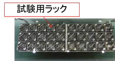
試験用ラックの水槽内設置状況
