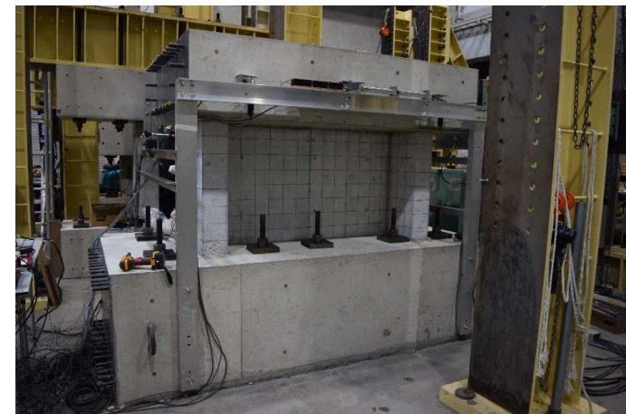
耐震実験:乾燥収縮が終局耐力に与える影響に関する 耐震実験[3]状況
